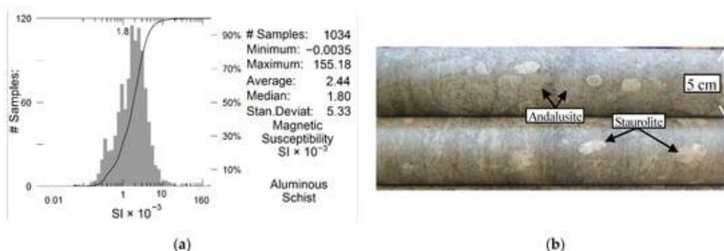
Рис. 12. Глиноземистый сланец. (а) Статистика и гистограммы измерений магнитной восприимчивости. (б) Изображение образцов керна.
