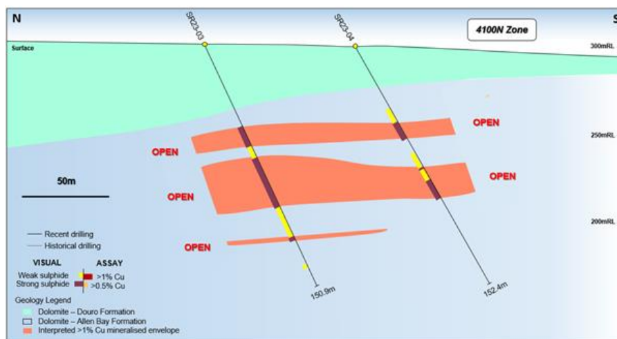
Рис. 3: Геологический разрез показывающий интерпретированную оболочку минерализации (>1% Cu) и недавние визуальные наблюдения в скважине.
