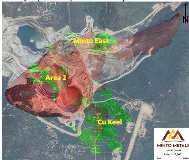
Рисунок 5. Карта рудника Минто (спутниковое изображение) и подземную разработку рудника (зеленый цвет) с прогнозируемым удельным сопротивлением 3D МТ, обрезанным на уровне 100 Ом-м.
