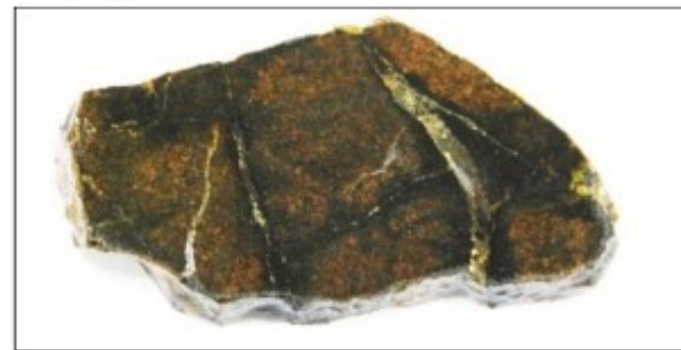
Вкрапленно-прожилковая урановая минерализация в сланце. Экспозиция радиографии образца 41 час. Канавка 8233, обр. Д-1.
