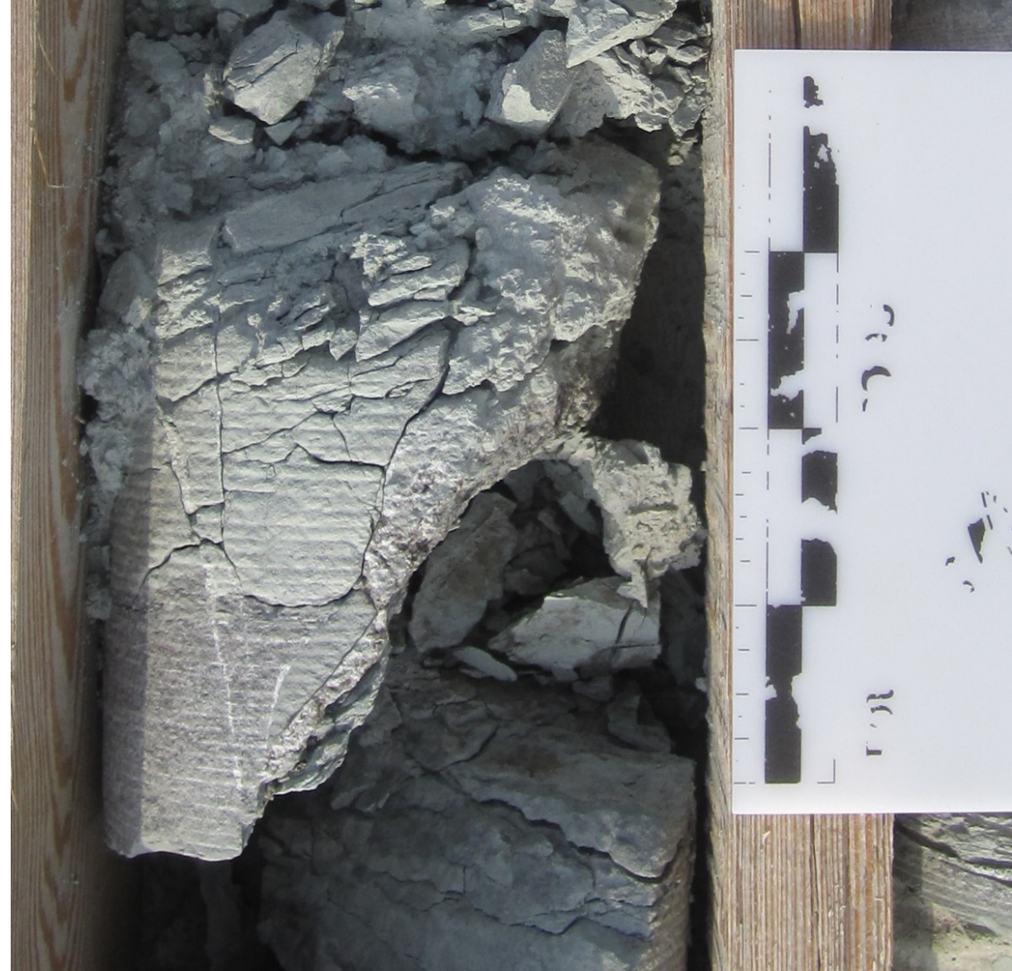
62,651-116,350-159 Газоразрывная (?) микробрекчия с кальцитовым цементом
