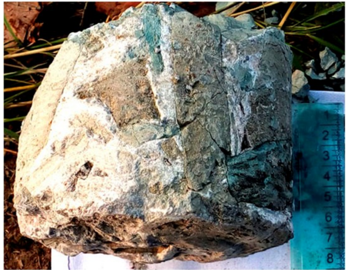
Карбонатная брекчия с обломками известняков и скарноидов из экзоконтактов Сюльдюкарских кимберлитов (скважина 12-20, глубина 103 м; фото А.А. Малькова)
