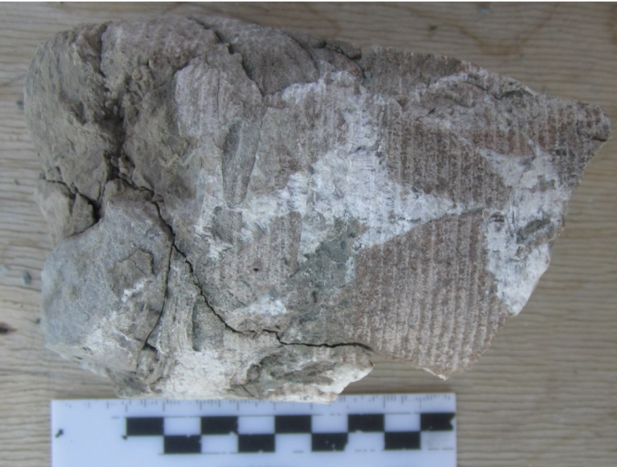
63.084-116.6-113.5м Флюидоразрывная брекчия. В обломках бурый доломит. В цементе кристаллический кальцит и глинисто-карбонатный материал.
