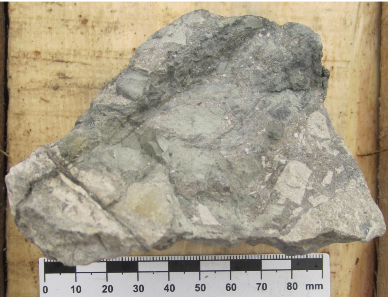
Тектоническая карбонатная брекчия с интенсивной пиритизацией. Скв. 147-97 глубина 51.5 м.
