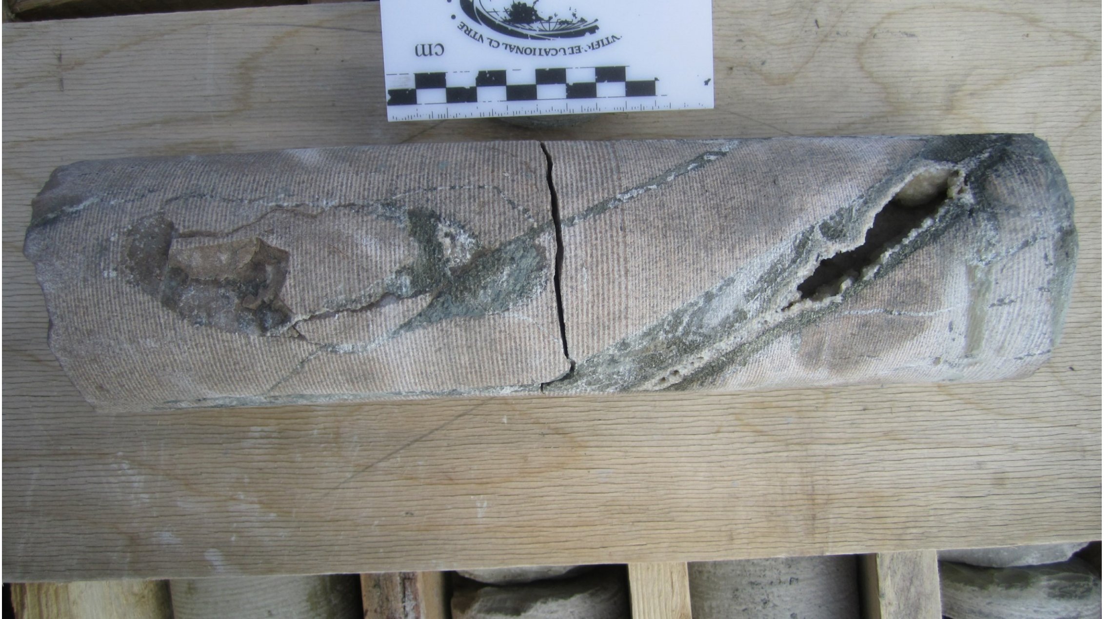
63.084-116.35-105м Флюидоразрывные прожилки в розовом мелкозернистом доломите, выполненные зеленым глинисто-карбонатным материалом, пиритом, битумом и кальцитом.
