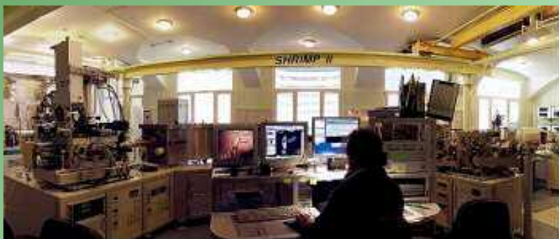
ЦИИ ВСЕГЕИ: Вторично-ионный микрозонд SHRIMP-IIe
