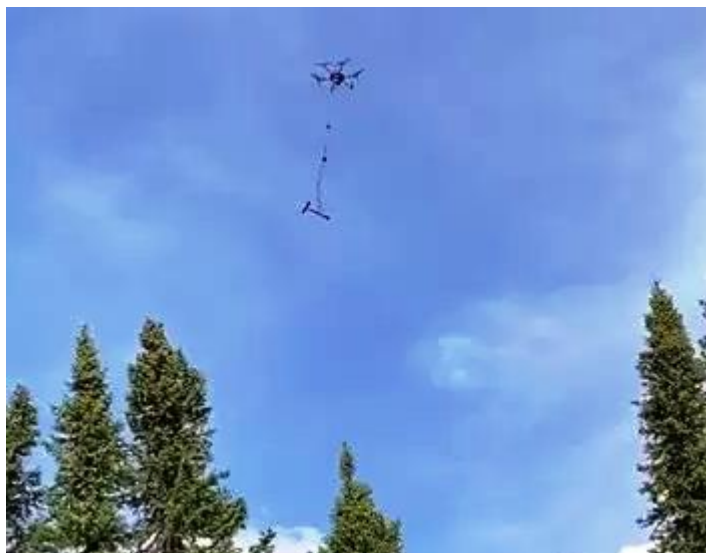
Магнитометр, измеряющий магнитную сигнатуру горных пород над литиевым участком Зоро.
