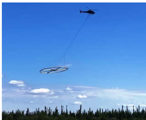
Рисунок 1: Воздушно-десантная система Аxiom Xcite TDEM в действии.
