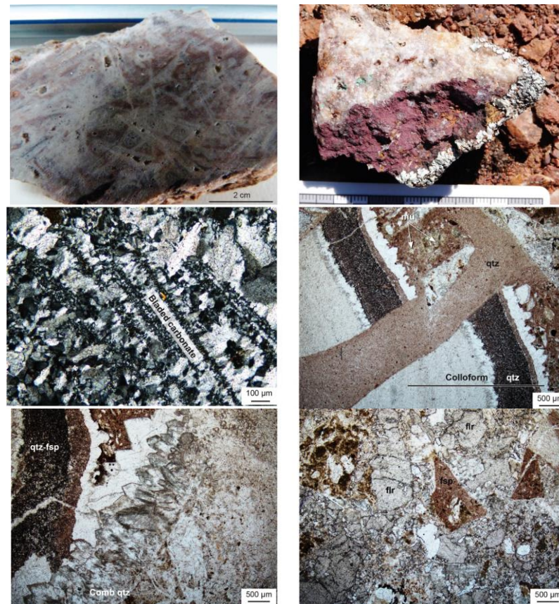
Рис. 8. Образец и микрофотографии эпитермальных брекчий кварцевых жил в районе озера Жиль.: а) образец брекчированной кварцевой жилы с флюоритом; б) образец эпитермальной кварцевой жилы с угловатыми серыми и красно-пурпурными кремнистыми обломками, окаймленными гребенчатым кварцем; в) решетчатый кварц, замещающий кальцит в красно-фиолетовой кремнистой основной массе; г) образец эпитермального кварца, состоящего из белого гребенчатого кварца с вторичным минералом Си; д) микрофотография, показывающая пластинчатые текстуры замещения карбоната в эпитермальной кварцевой жиле (кросс-поляризованный свет); е) микрофотография, показывающая рост коллоформного кварца. Ранний кварц с последовательной полосчатостью и окаймленный гребенчатым кварцем пересечен и замещен более поздними наростами с преобладанием кварца. Обе стадии роста кварца пересекают мелкозернистую матрицу кварца, полевого шпата и мусковита (мю) (плоскополяризованный свет); г) микрофотография гребенчатого кварца (qtz), заполняющего полость в основной массе из кварц-полевого шпата (qtz-fsp) (плоскополяризованный свет) и; з) микрофотография брекчированной эпитермальной кварцевой жилы с обильными обломками флюорита (flr) и угловатого полевого шпата (fsp) в богатой кварцем матрице (плоскополяризованный свет).
