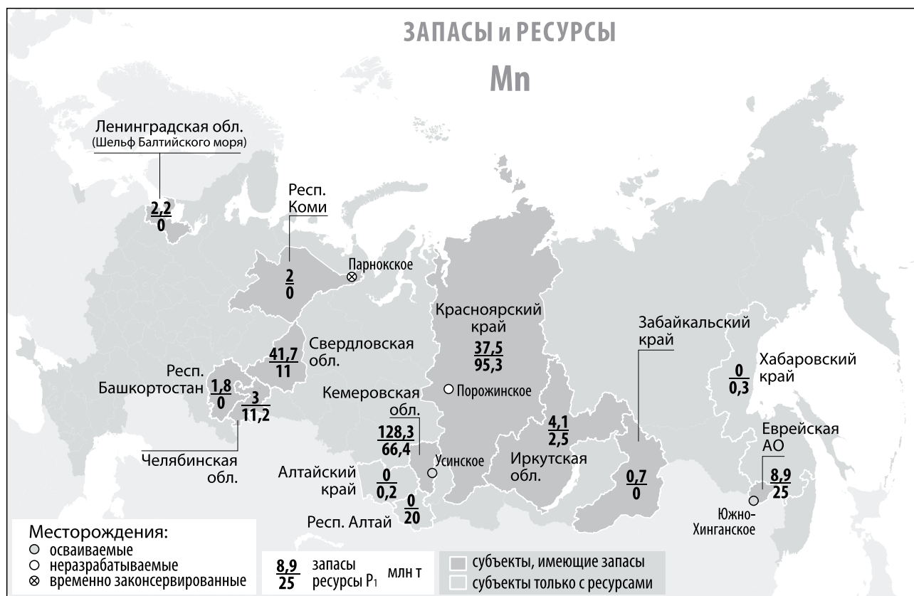
Основные месторождения марганцевых руд и распределение их запасов и ресурсов категории P_1 по субъектам Российской Федерации, млн т
