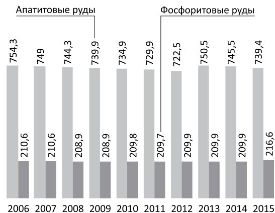
Динамика движения запасов категорий А+В+С 1 апатитовых и фосфоритовых руд в 2006–2015 гг., млн т P_2O_5
