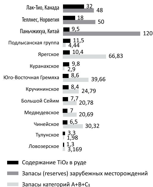
Запасы российских коренных месторождений категорий A+B+C 1 и запасы (reserves) зарубежных разрабатываемых коренных месторождений титана, млн т, и содержания в них TiO_2 , %
