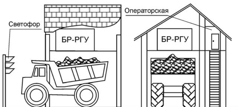
Рис. 2.10. Схема рудоконтролирующей станции РКС-А (ООО «РАДОС») с модулем блока рентгеновского и реперного устройства (БР-РГУ).
