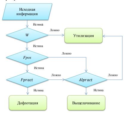
Рис. 14 Алгоритм выбора способа переработки текущих хвостов обогащения
