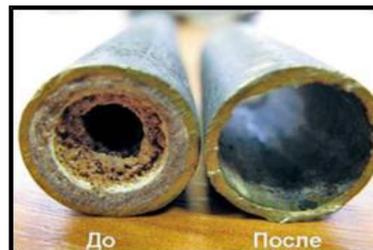
Очистка внутренней поверхности обсадных труб скважины от кольматантов в результате обработки раствором бифторида аммония
