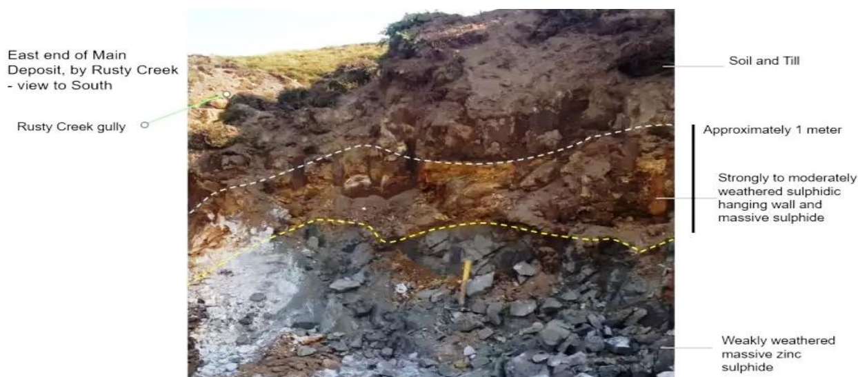
Фото. 1. При вскрыше было удалено 3 м выветрелых пород, обнаживших сульфиды.
