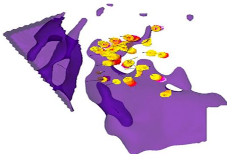
Рис. 6 - 3D-изображение, показывающее интенсивность филловых изменений на контурах скважин (от желтого к розовому и удельное сопротивление <120 ом-м (фиолетовый фон).
