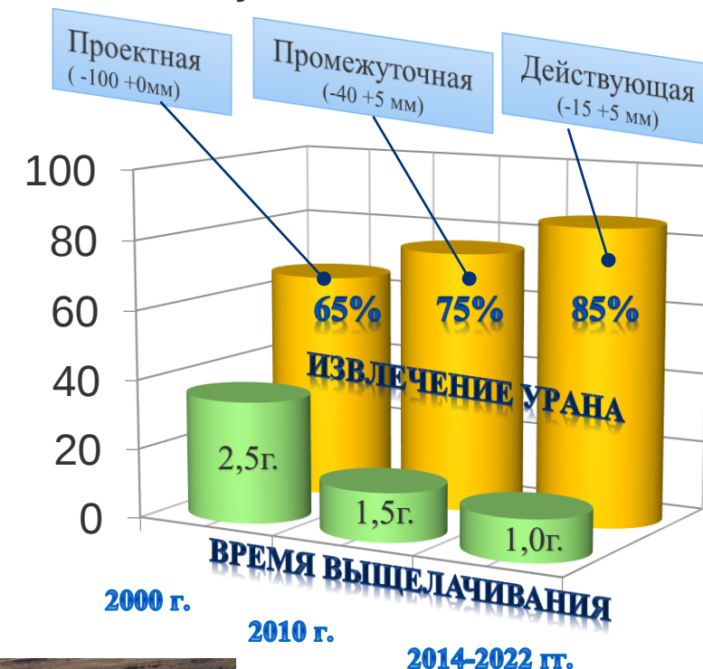
Схемы кучного выщелачивания
