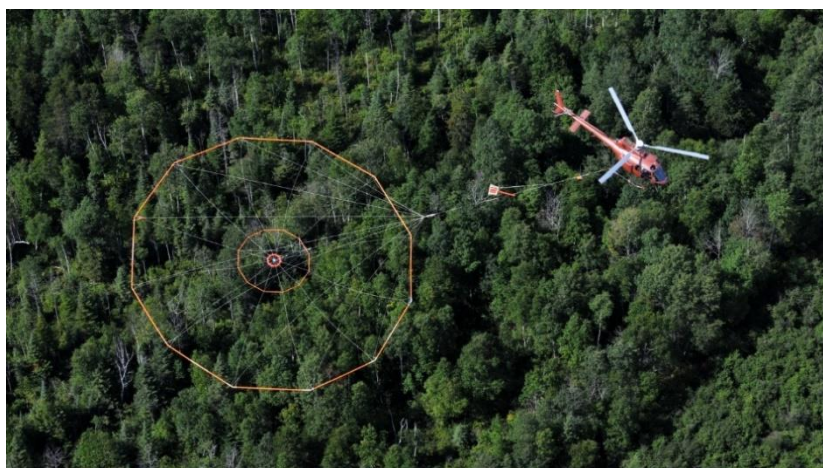
Рис. 2: GeotechLtd. Система VTEM™ для сбора данных в полевых условиях.
