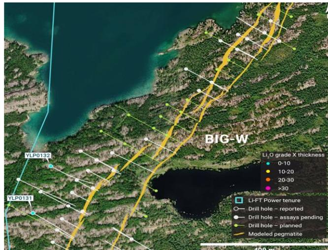
Рис. 5 – Вид в плане, пегматита БИГ-Вест с бурением
