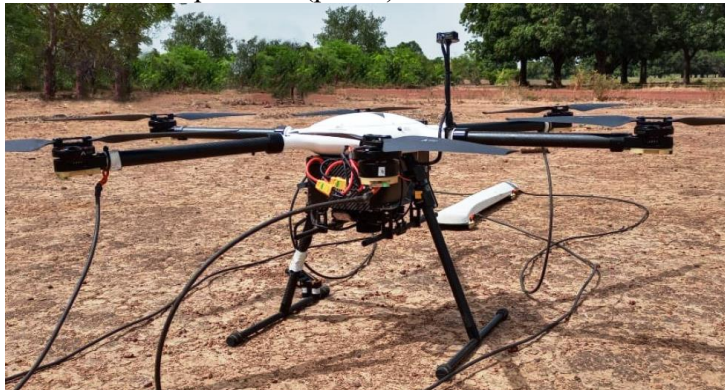
Рис. 3: Магнитная система БПЛА AeroPhysX с магнитометром MagArrow.
