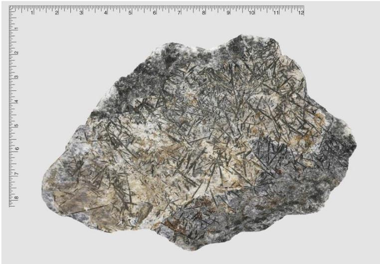
Кристаллы холмквистита -  $\text{Li}_2(\text{Mg}_3\text{Al}_2)[\text{Si}_8\text{O}_{22}](\text{OH})_2$  в образце метагаббро
