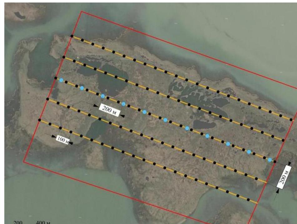
Эффект трехмерности достигается за счет объемности (распределение точек измерений в пространстве) и векторности (ориентировка позиций приемных линий ортогонально друг к другу)
