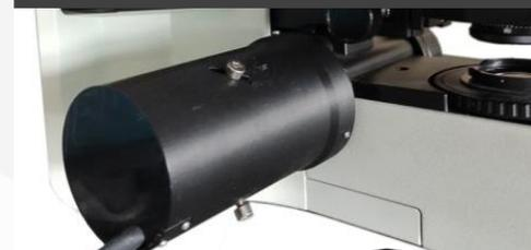
Моторизованный привод Z-фокусировки
