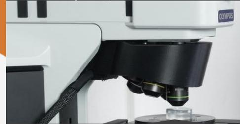
Моторизованный привод револьвера объективов
