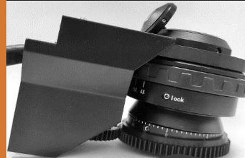
Моторизованный привод поворотного анализатора и поворотного поляризатора проходящего света
