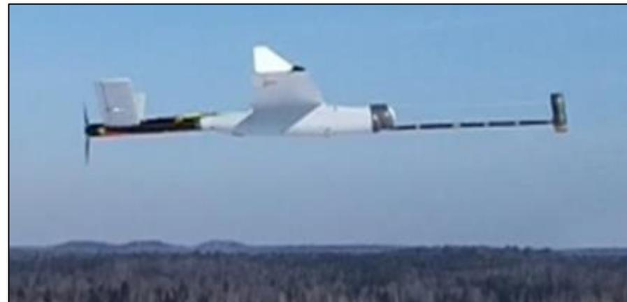
АО «Росгео» совместно с АО «ZALA AERO» разработан беспилотный воздушный комплекс ZALA 421-16E4 для аэромагнитной съемки высокой точности – 0,34 нТл (самой высокой в России и мире). С характеристикой: 6 часов полета, дальностью до 200+ км, t -40°C...+50°C.
