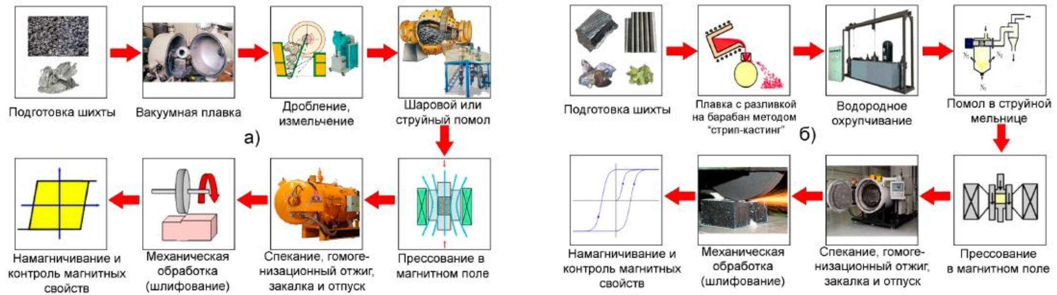
Упрощенные схемы производства постоянных магнитов из МТМ на основе сплавов РЗМ (а – сплавы системы Sm-Co, б – сплавы системы Nd-Fe-B)
