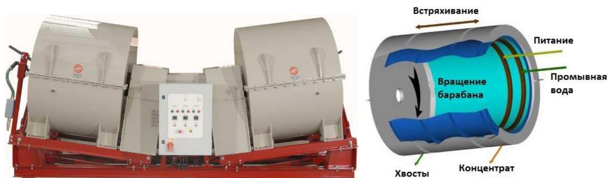
Рисунок 20 — Мультигравитационный сепаратор SCMG3, устройство барабана в мультигравитационном сепараторе
