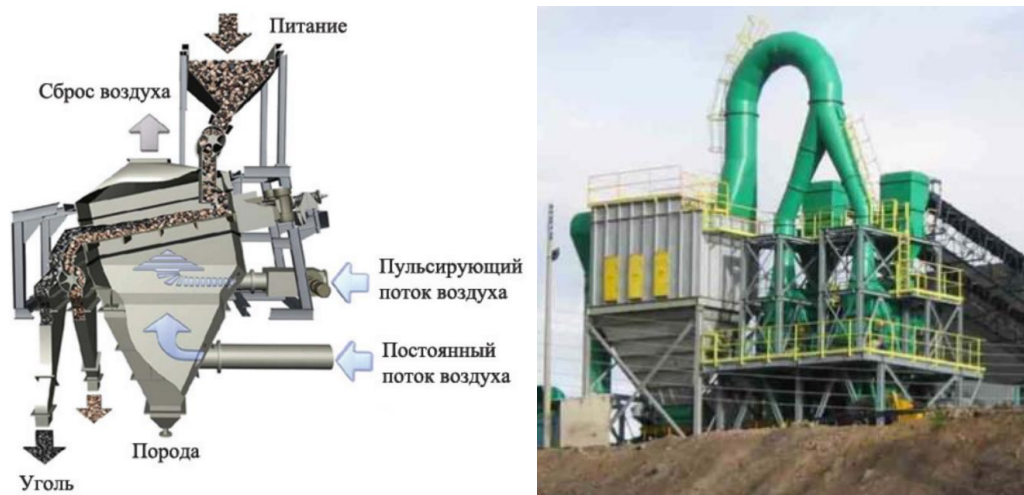
Рисунок 14 — Конструкция и внешний вид пневматической отсадочной машины Allair компании Allmineral
