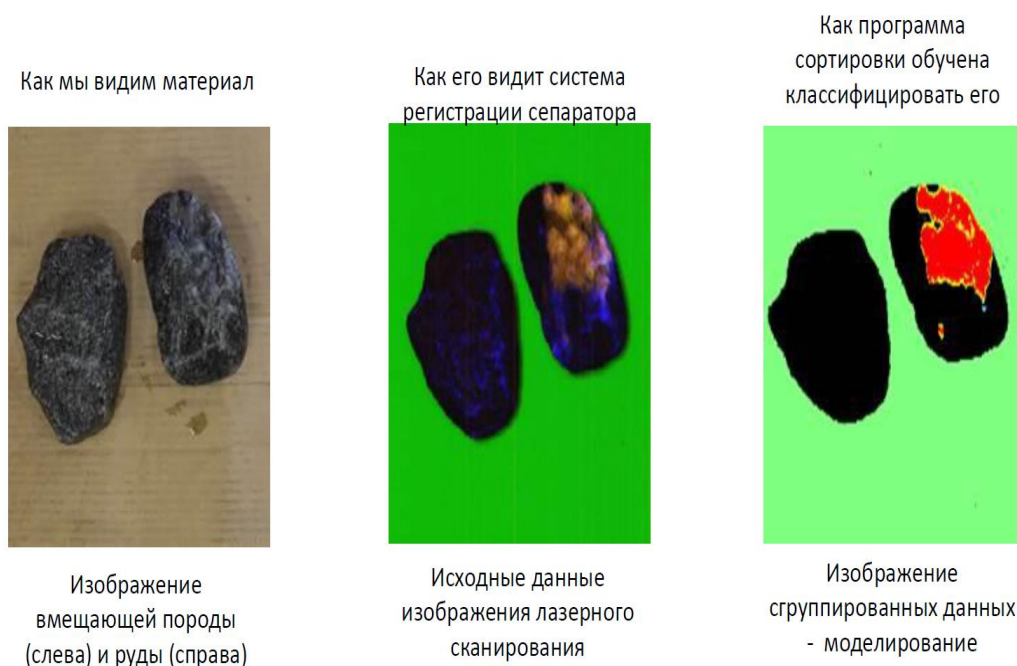
Рисунок 12 — Пример распознавания слабовыраженной кварцевой цветовой разности на куске лазерной системой сепаратора
