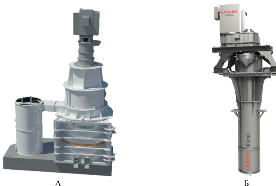
Рисунок 6 — Вертикальные мельницы тонкого измельчения: А — тип Vertimill (Metso); Б — тип HIGmill (Outotec)
