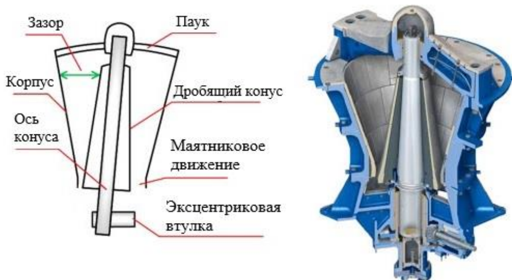
Рисунок 1 — Общий вид гириционной дробилки
