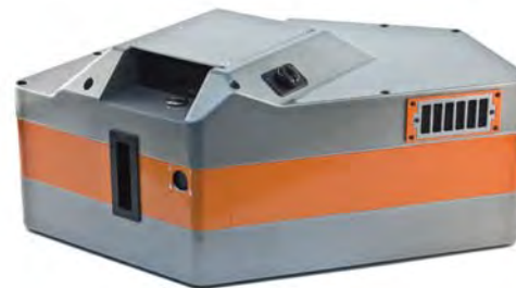
Авиационный гиперспектрометр, позволяющий получать аэроснимки в 625 каналах, с разрешением – 1м;
