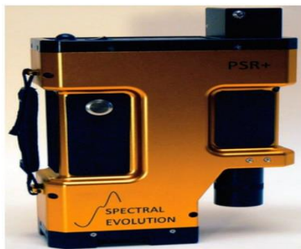
Фото. 1. Портативный спектрорадиометр для полевой геологии в УФ–видимом и инфракрасном диапазоне
