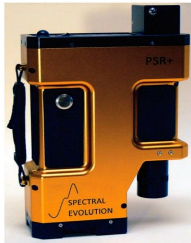
Рис. 2. Портативный спектрорадиометр в УФ–видимом и инфракрасном диапазоне (диапазон 250-2500 нм)
