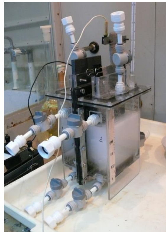
Лабораторный двухкамерный электролизер. Объем камеры – 1 л
