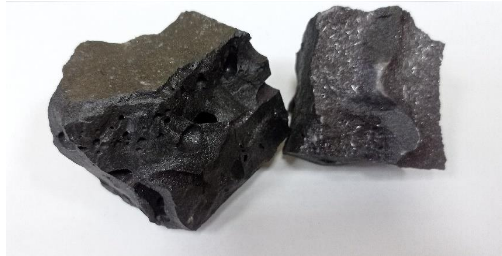
Образцы металла и шлака, полученные при проведении укрупненных испытаний
