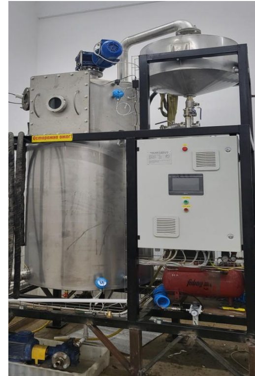
Азеотропная сушка в испарителе
