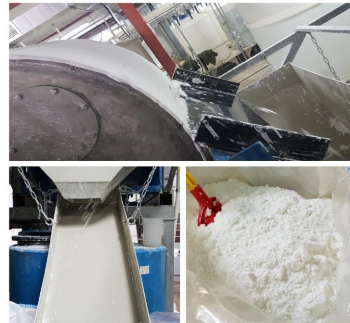
Фильтрация карбоната церия на барабанном фильтре
