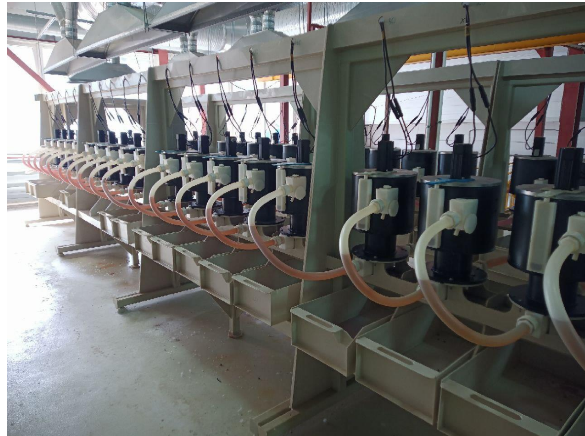
Каскад центробежных экстракторов, модель ЭЦ-1000 ПБ, число ступеней -93
