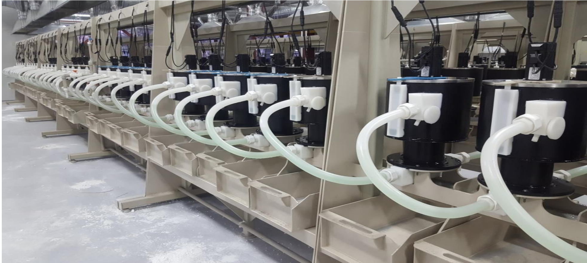
Каскад центробежных экстракторов, модель ЭЦ-1000 ПБ, число ступеней -83
