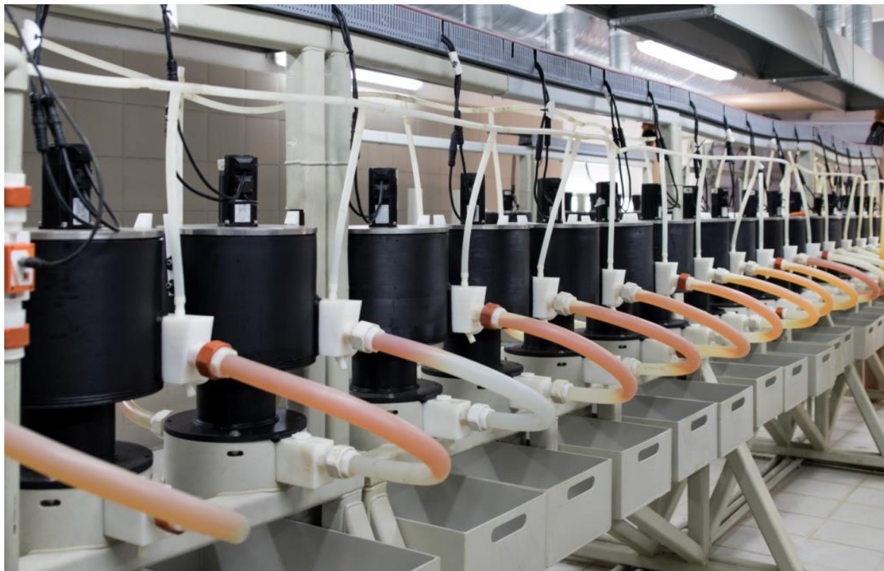
Каскад центробежных экстракторов модель ЭЦ-1000ПБ, число ступеней 25
