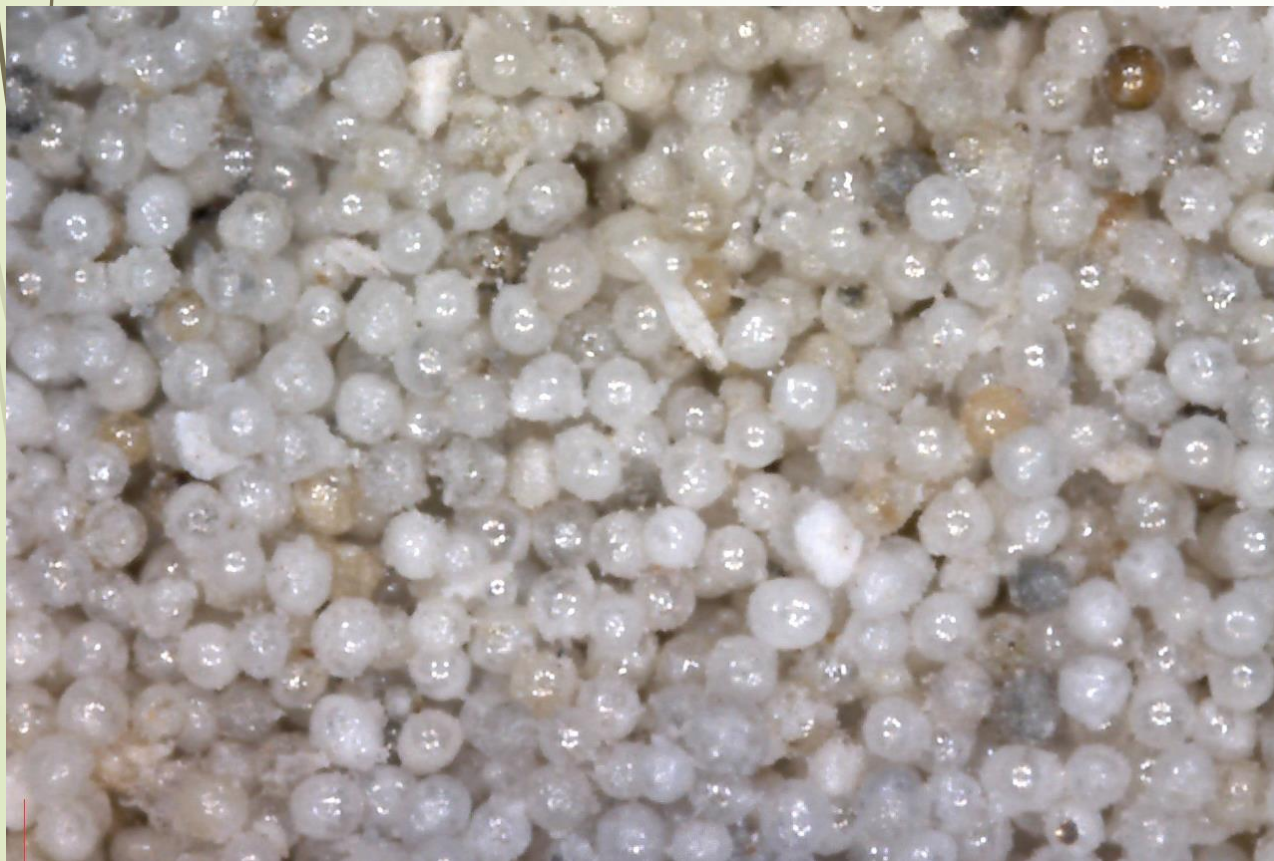
Общий вид алюмосиликатных микросфер при увеличении x 220
