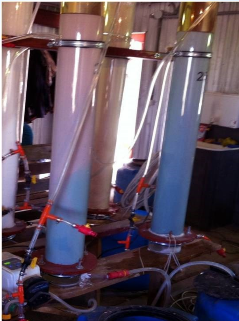
* Рисунок 8 Сорбционная очистка растворов
