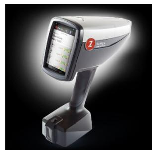
**Портативный гамма-спектрометр GT32 (RS230)** на основе BGO детектора (определение содержания Ra, Th, K)
