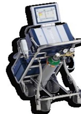
**Bruker Q4 MOBILE** мобильный оптико-эмиссионный спектрометр (мультиэлементный анализ)
