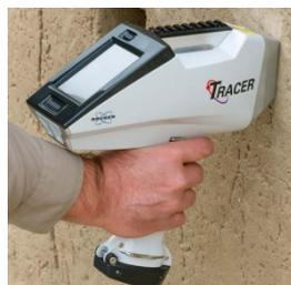
**Рентгено-флуоресцентный портативный спектрометр TRACER 5i** (мультиэлементный анализ от Na-Am)
