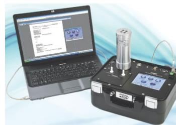
**Портативный лазерный анализатор/спектрометр Laser-Z500** на основе спектроскопии возбуждения лазерным пробоем (мультиэлементный анализ от H – U)
