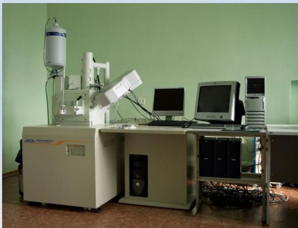
Сканирующий электронный микроскоп JEOL JSM-6480LV с энергодисперсионным и волновым спектрометрами –микронзондовый аналитический комплекс
