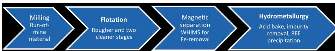
Рисунок 2: Упрощенная технологическая схема для прямой флотации отработанного материала
