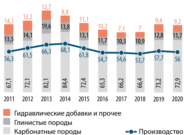
Рис. 2 Динамика добычи цементного сырья (по видам сырьевых компонентов) и производства цемента в 2011–2020 гг., млн т
