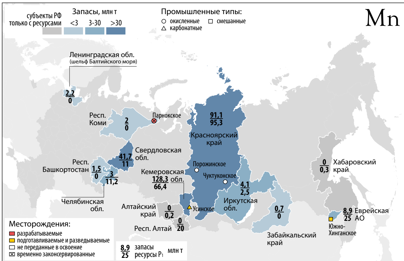
Рис. 6 Распределение запасов и прогнозных ресурсов категории Р 1 марганцевых руд между субъектами Российской Федерации (млн т) и их основные месторождения
