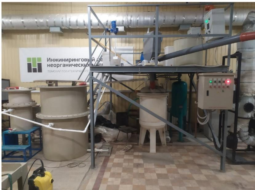
Рис. 12. Установка по обескремниванию шлака
