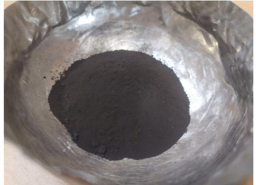
Рис. 15. Обескремненный шлак после обжига
