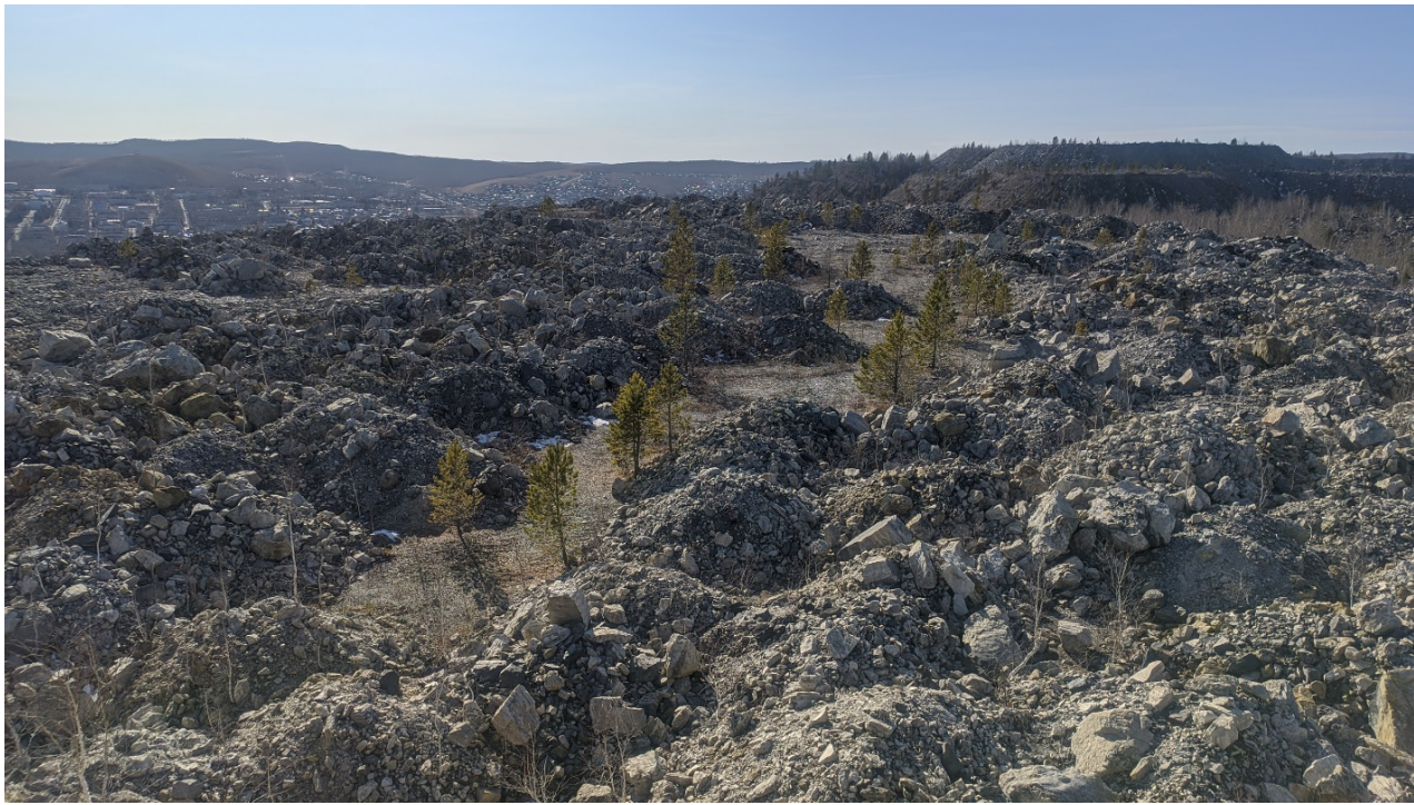
Завал поверхности отвалов негабаритными глыбами.
