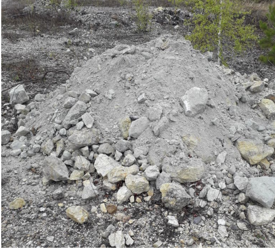
Гранулометрический состав отвалов из шурфа на поверхности отвалов. Видна высокая степень выветрелости обломков
