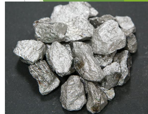
Феррониобий - ферросплав, содержащий около 60-70 % ниобия (или ниобия и тантала)
