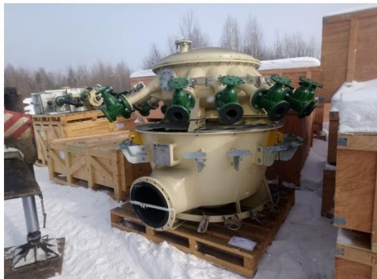
Гидроциклоны от Multotec Process Equipment. Март 2021г.
