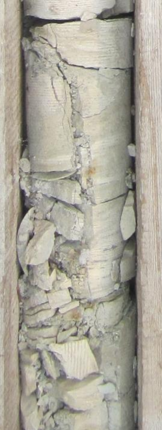
Зона рассланцевания с пиритом. Скважина 73,5- 222,5 глубина 43 м.
