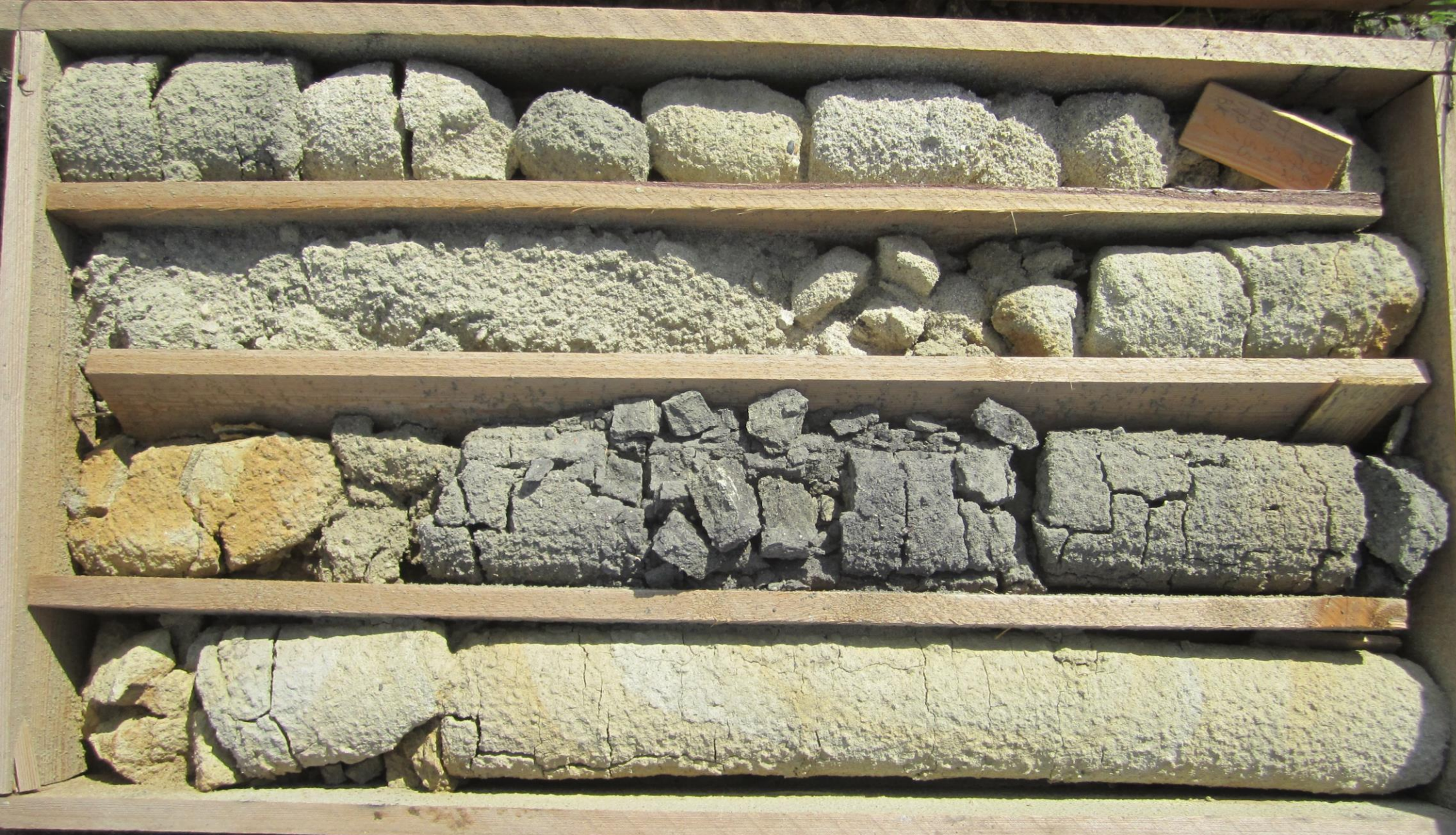
60.8-117.2-54-55м. В лимонитизированных крупнозернистых песчаниках (P2br) прослой тёмно-серого гравийного углистого песчаника
