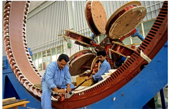
Ручная вставка около 9 т медных обмоток в ветровую турбину
